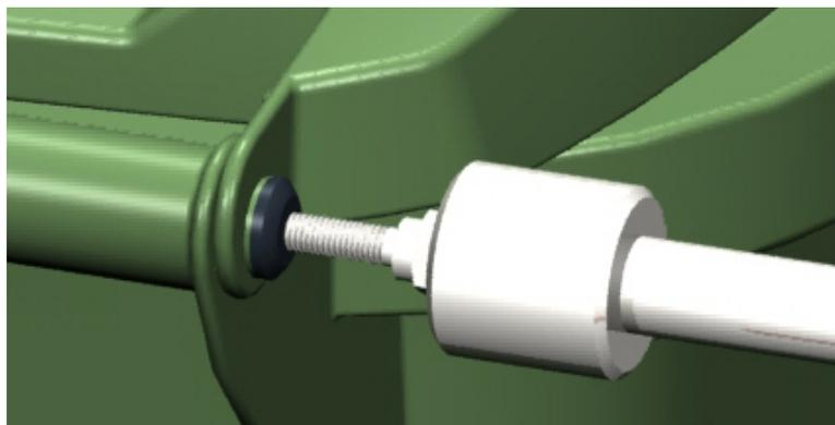
Danach die Griffmasse des Demontagewerkzeuges ruckartig so oft (ca. 3-4 mal) in Pfeilrichtung zum hinteren Anschlag bewegen (siehe Darstellung), bis sich der Bolzen gelöst hat. Da die Scharnierbolzen Gebrauchsspuren aufweisen, dürfen sie nicht weiter verwendet werden.
